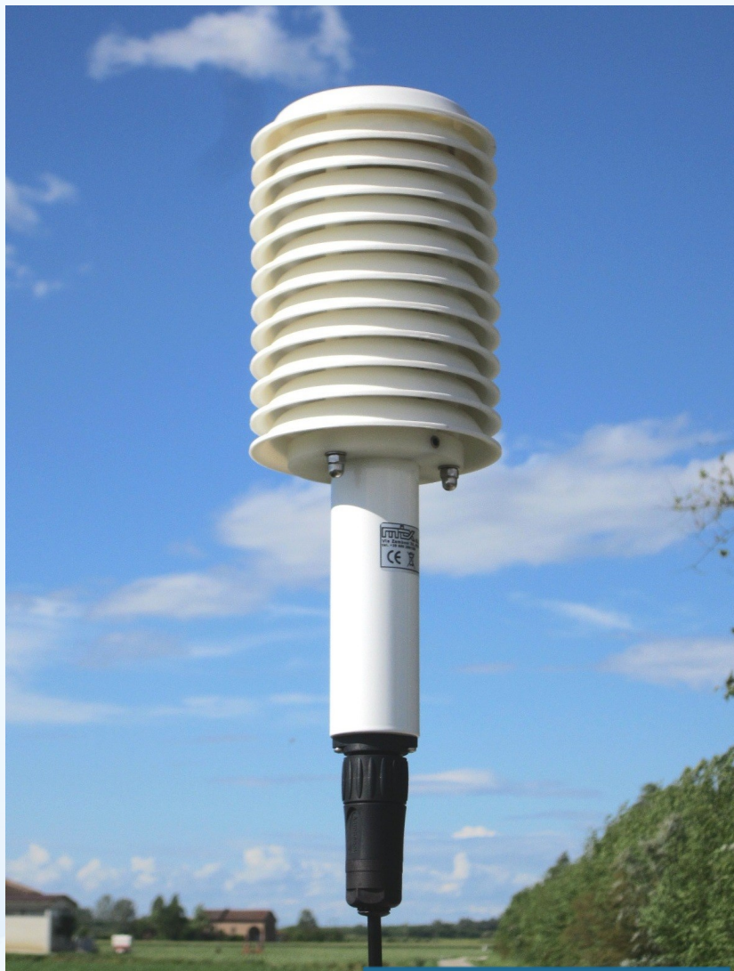
Termometro con schermatura a ventilazione naturale
